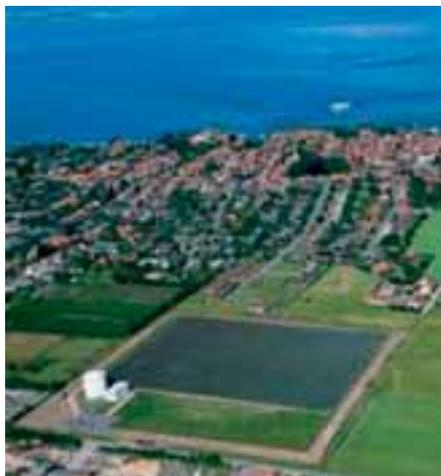
a) L'impianto solare per il riscaldamento di un distretto più grande d'Europa misura 20.000 m<sup>2</sup>; Marstal, Denmark – ESTIF
